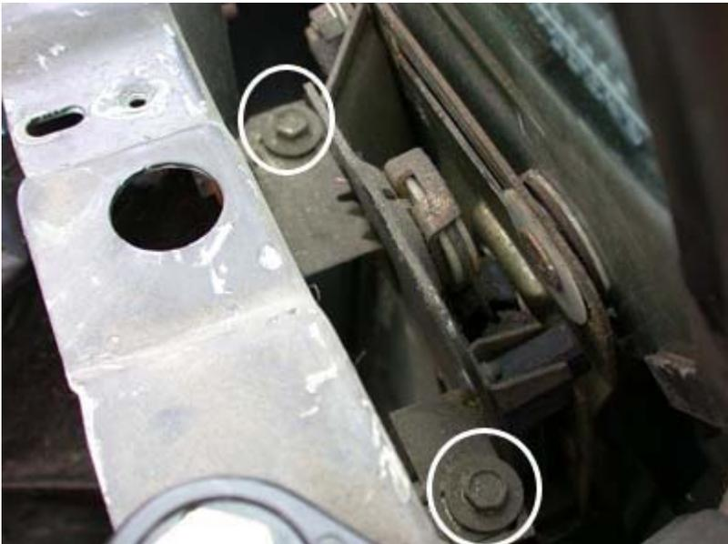
4. Dévisser le boulon du support bas du mécanisme de lève vitre.
