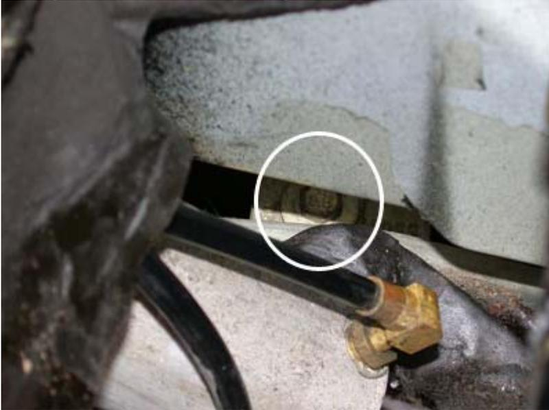
5. Dévisser les 2 boulons du support bas de mécanisme de lève vitre
