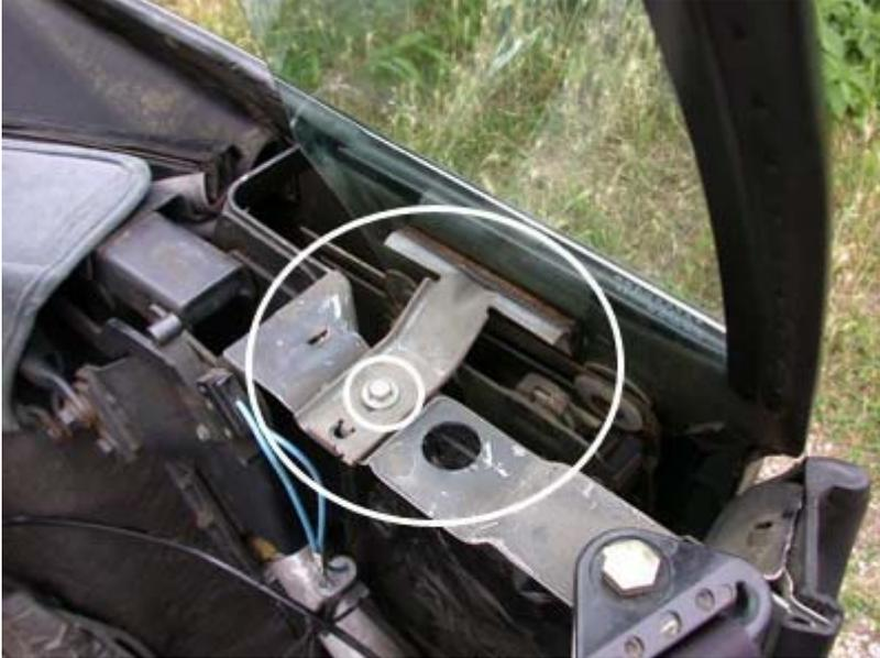
3. Dévisser les boulons du support haut du mécanisme de lève vitre. (de chaque côté). Pas la peine de tenter d'ôter l'ensemble du bloc dossier / accoudoirs, celui-ci est très fermement maintenu en place par des boulons accessibles seulement après démontage complet.
