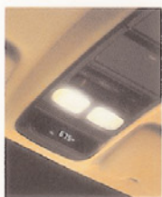
La console de pavillon comprend notamment un rangement pour les lunettes, un affichage de la température extérieure, une boussole, un ordinateur de bord multi-fonctions et des spots de lecture pour les passagers avant et arrière.
