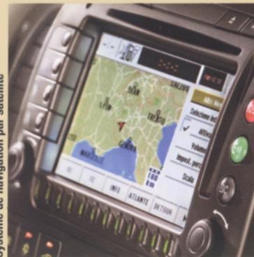
**CONNECT.** Système info-télématique de la dernière génération avec afficheur en couleurs à matrice active de 6,5", lecteur de CD, système de navigation par satellite intégré dans la planche de bord, autoradio, téléphone GSM bi-bande avec fonction " mains libres " et commandes vocales.
