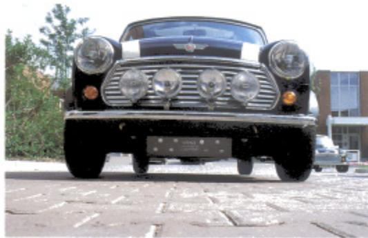
Abb. 2 Cooper-Grill, H4-Einsätze für Hauptscheinwerfer, Zusatzscheinwerfer, Ölwanenschutz
