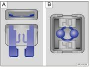
Fig. 159 Blown fuse: : Blade fuse. : Cartridge fuse.
