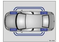
Fig. 176 Tire rotation diagram.
