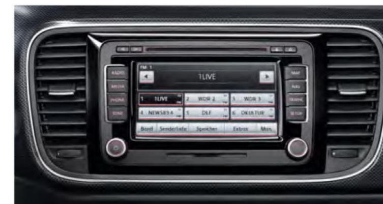
Das **Radio-Navigationssystem „RNS 510“** mit Sprachbedienung, Picture Navigation, Touchscreen, großem Farbdisplay, DVD-Laufwerk, 30-Gigabyte-Festplatte, SD-Kartenschacht, AUX-IN-Buchse und Verkehrszeichenerkennung ist mit vorinstallierten Europakarten ausgestattet. |so
