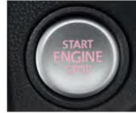
Für höchsten Komfort steht das **schlüssellose Schließ- und Startsystem „Keyless Access“**. Eine ausgeklügelte Funk- und Sicherheitstechnik ermöglicht das Öffnen und Schließen ohne aktive Nutzung des Schlüssels. Das Starten und Abstellen des Motors erfolgt per Knopfdruck. |so
