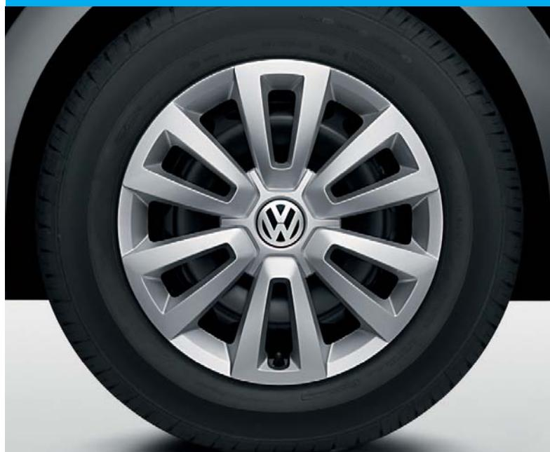
La jante en acier de 16 pouces est chaussée d'un pneu 215/60 R16. De série sur finition 'Coccinelle'.
