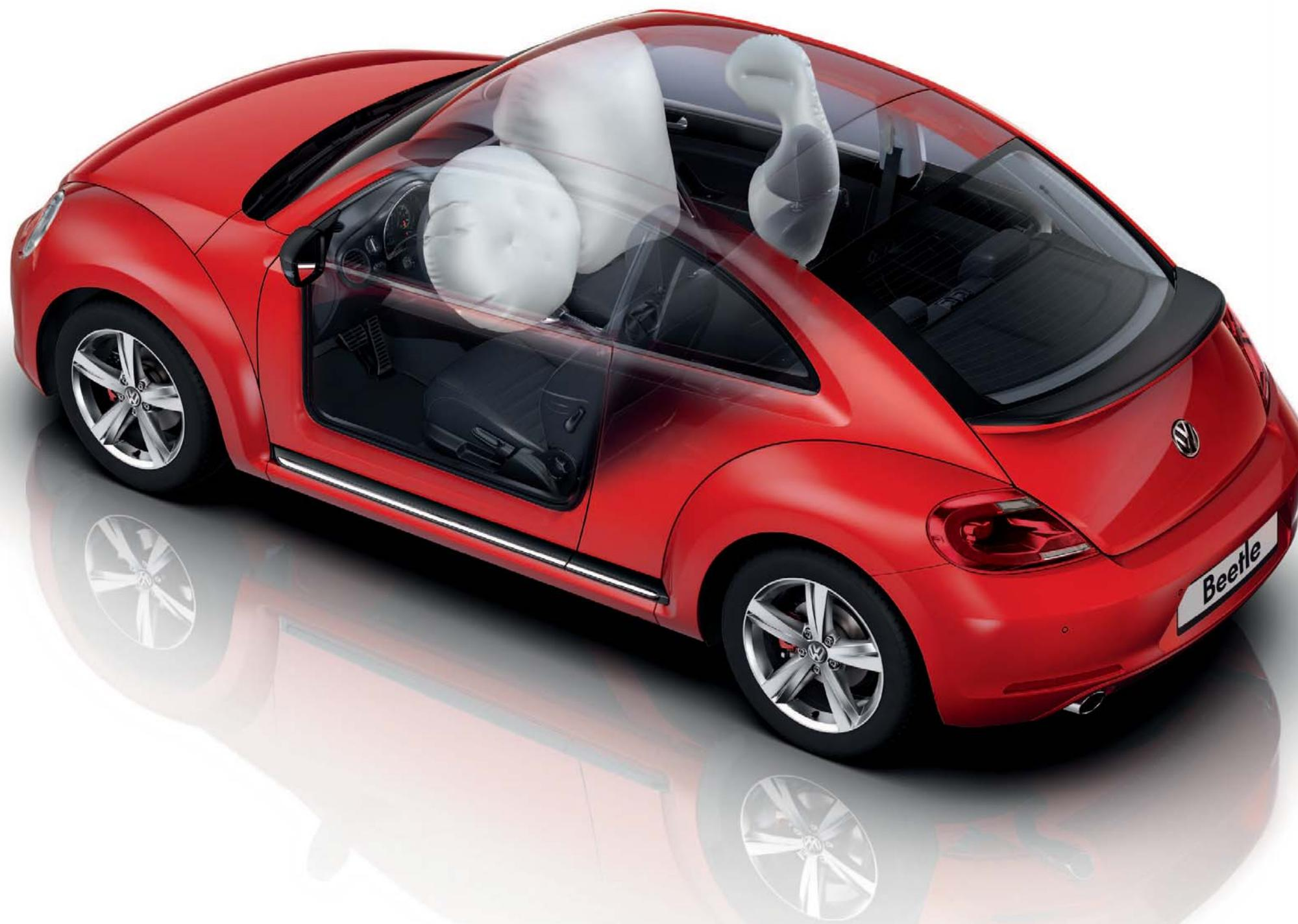
Le système d'Airbags comprend des Airbags frontaux à l'avant (celui du passager avant désactivable) ainsi que des Airbags de tête et latéraux combinés pour les passagers avant. En cas de choc, ces Airbags se déclenchent en quelques millièmes de seconde et leurs coussins sont remplis par un générateur de gaz. Ils réduisent nettement le risque de blessure, en particulier au cou et à la nuque.
