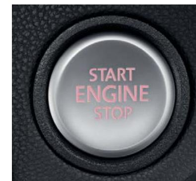
Du confort en plus : voilà ce que vous offre le système de verrouillage et de démarrage sans clé 'Keyless Access'. Une technique radio sophistiquée permet d'ouvrir et de fermer les portières sans prendre la clé dans la main. Pour démarrer et arrêter le moteur, on appuie sur un bouton. En option.
