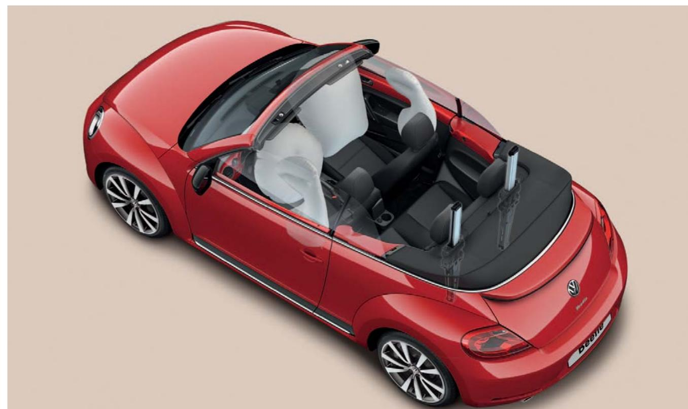
Le **dispositif de protection** en cas de retournement est constamment activé, que la capote soit ouverte ou fermée. Ses profils renforcés se déploient automatiquement en quelques milli-secondes en cas de besoin. Associé au système d'airbags, ce dispositif renforce sensiblement la protection de tous les passagers à bord du véhicule.
