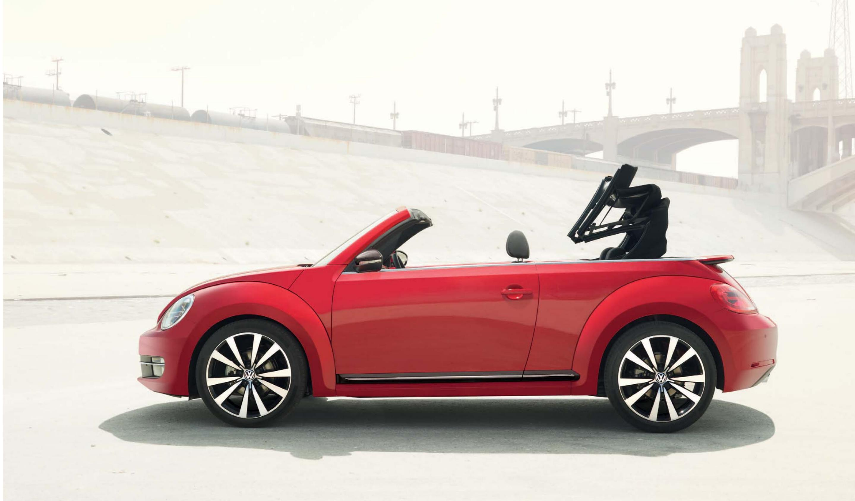
La **capote** est un hommage à la première Coccinelle Cabriolet, 100 % automatisée, elle s'ouvre en 'Z' en seulement 9,5 secondes et ce jusqu'à 50 km/h. La lunette arrière en verre de sécurité et ses joints à bourrelet en Mylar ainsi que les 3 épaisseurs de la capote, atténuent les bruits parasites de l'extérieur et résistent à toutes les conditions climatiques. La capote est disponible en Noire ou en Beige Nutria, en fonction de la couleur de la carrosserie avec couvre-capote noir. De série.
